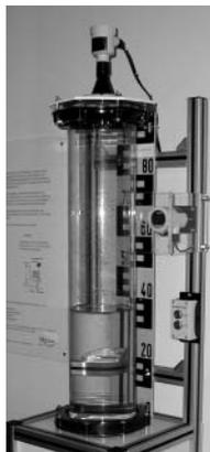
Zum Ausprobieren: Radarpegelmessgerät
