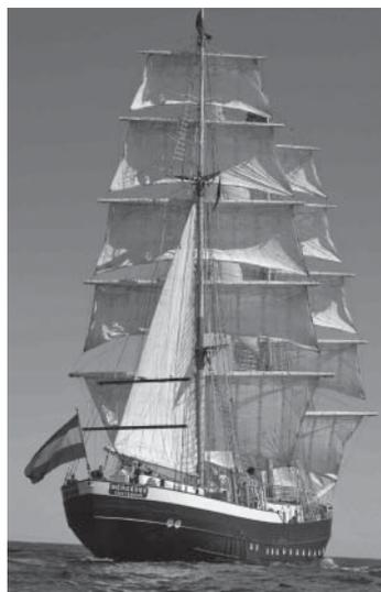
Die Brigg „Mercedes“ ist eines der jüngsten Schiffe in der internationalen Flotte der Großsegler. Das 50 m lange Schiff verfügt über 18 Segel mit insgesamt 900 m<sup>2</sup> Segelfläche, die das Schiff bis 16 Knoten (ca. 30 km/h) schnell machen. An Bord ist Platz für bis zu 135 Passagiere.
