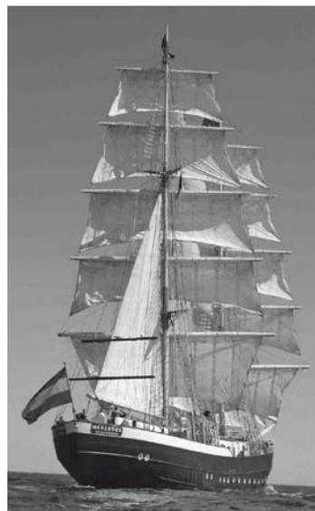
Die Brigg „Mercedes“ ist eines der jüngsten Schiffe in der internationalen Flotte der Großsegler. Das 50 m lange Schiff verfügt über 18 Segel mit insgesamt 900 m<sup>2</sup> Segelfläche, die das Schiff bis 16 Knoten (ca. 30 km/h) schnell machen. An Bord ist Platz für bis zu 135 Passagiere.
