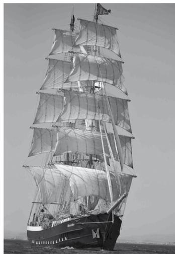
Die Brigg „Mercedes“ ist eines der jüngsten Schiffe in der internationalen Flotte der Großsegler. Das 50 m lange Schiff verfügt über 18 Segel mit insgesamt 900 m<sup>2</sup> Segelfläche, die das Schiff bis 16 Knoten (ca. 30 km/h) schnell machen. An Bord ist Platz für bis zu 135 Passagiere.
