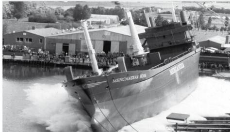
Schiffsneubauten wurden auf der Büsumer Werft immer quer zur Fahrtrichtung dem nassen Element übergeben. Stapelläufe wie dieser lockten jedes Mal unzählige Schaulustige an
